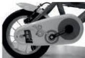
fig. 2 Controllare che ci siano le due viti dello stabilizzatore avvitate al telaio.
